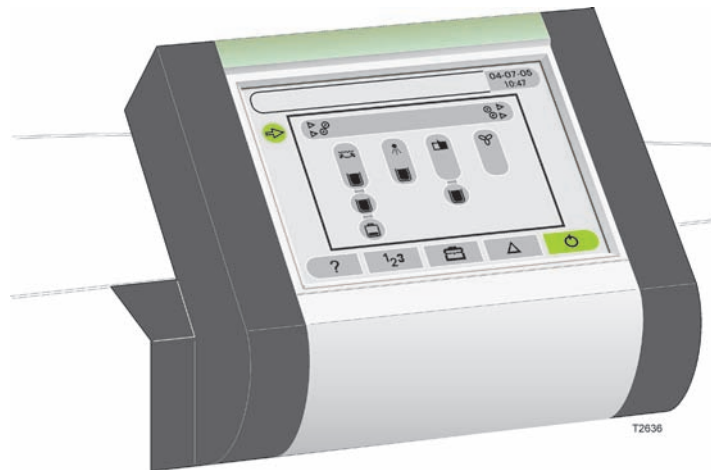
一个由四部分组成的冲版机的控制面板示例
